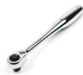
**K 4135 D** Компактная храповая головка с кнопкой быстрого освобождения. Для реверсивного стопорного механизма с 72 усиленными зубцами необходимо перемещение всего на 5°. Корпус из полированной хром-ванадиевой стали с резиновой накладкой для лучшего захвата.
