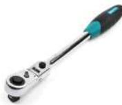
**K 4131 D** Длинный гибкий ключ с храповым механизмом, небольшая головка идеальна для работы в труднодоступных местах. Кнопка быстрого освобождения головок утоплена в корпус. Механизм с минимальным шагом, 72 зубца, для перемещения необходимо всего 5°. Реверс включается поворотной шкалой, рукоятка имеет эргономичный дизайн поверхностей трения.
