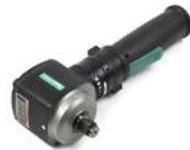
Ударный механизм с двойным молотом, регулируемый выпуск воздуха и простое управление прямым/обратным ходом, а также регулируемый трехступенчатый крутящий момент повышают удобство эксплуатации этого гайковерта.
