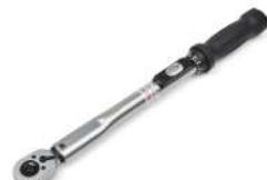
**K 2740** Для затяжки по часовой стрелке с выбранным крутящим моментом и погрешностью  $\pm 3\%$ . Установочная шкала проградуирована как в Ньютонах, так и в кгс-метрах. При достижении заданного момента раздаётся щелчок и дальнейшее затягивание прекращается.
